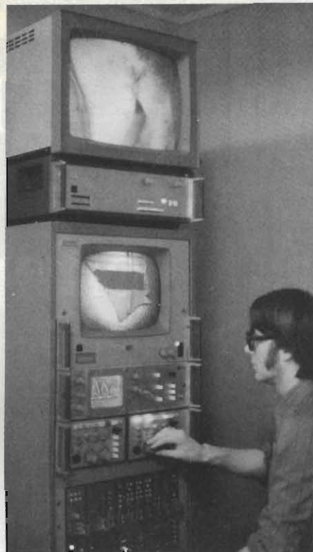
Fig. 3 - Telecamera trasportabile combinata con un endoscopio a fibre ottiche impiegato per l'esame dello stomaco. (a destra). L'immagine può essere osservata anche su un monitor TV.
