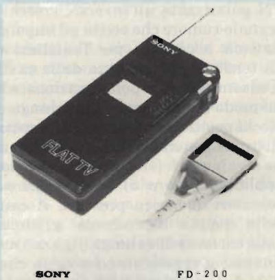
Fig. 1 - La Sony, nonostante sia partita con la tecnologia dello schermo gigante, ha ora realizzato un cinescopio a schermo piatto di dimensioni estremamente ridotte. Il televisore nel quale questo cinescopio viene impiegato, misura infatti 198 x 87 x 33 mm.
