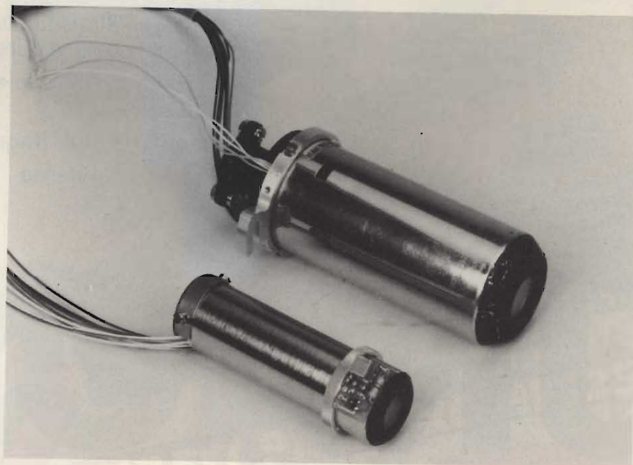
Fig. 2 - Struttura elettrodica, bobina di deflessione e connettore esterno per gli elettrodi del Plumbicon da 8 mm
