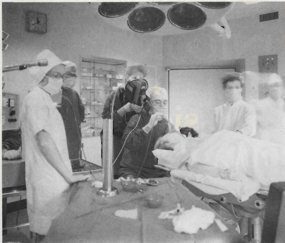
Fig. 3 - Telecamera trasportabile combinata con un endoscopio a fibre ottiche impiegato per l'esame dello stomaco. (a destra). L'immagine può essere osservata anche su un monitor TV.
